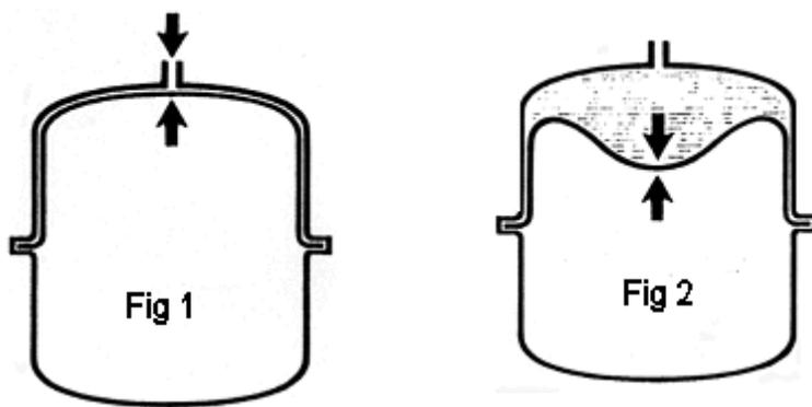
1. La pression de remplissage dans l'installation et la pression initiale d'azote sont identiques. Il n'y a aucune possibilité d'un approvisionnement du réservoir.
